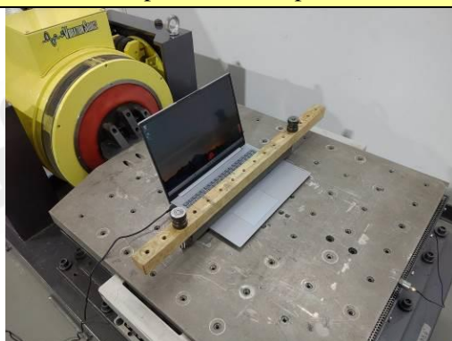
29. Vibration Test--I: Y axis
