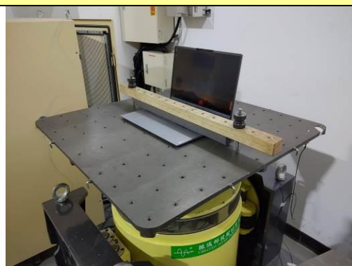
30. Vibration Test--I: Z axis
