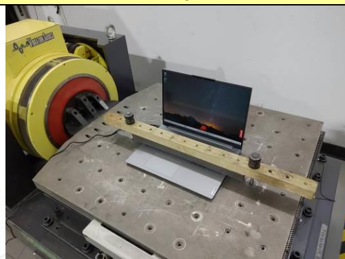
28. Vibration Test--I: X axis
